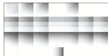
Bei der gleichen Konvertierung mit ICC geht der ursprüngliche Schwarzkanal verloren und ist vierfarbig aufgebaut.
