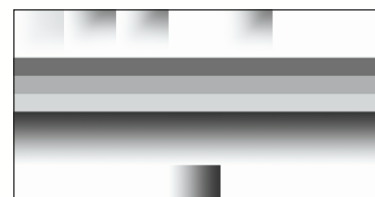
Nach der Konvertierung zu ISOcoated_v2 (39L) mit GMG: der ursprüngliche Schwarzkanal bleibt erhalten.
